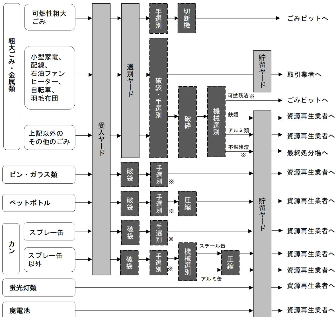
※ビン・ガラス類、ペットボトル、カンの処理工程において発生する可燃残渣・不燃残渣は、粗大ごみ・金属類の処理工程と同様に処理する。
